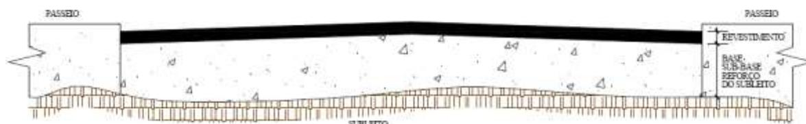
O problema geral do dimensionamento consiste em considerar um ponto P qualquer do sistema, no subleito ou no pavimento e determinar, para este ponto, quando o sistema é solicitado por uma carga de roda Q, o estado de tensão, a deformação e se vai ou não, haver ruptura.
